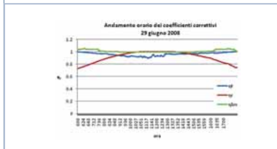
FIGURA 18 - Andamento dei fattori correttivi del rendimento per un pannello fotovoltaico sul campo: \eta_t = effetto della temperatura, \eta_r = effetto del coefficiente di rinvio del vetro, \eta_{\lambda m} = effetto della massa d'aria e della risposta spettrale. Laboratori di Fisica Tecnica Ambientale - Roma Tor Vergata, Giugno 2008. (Fonte: 35)
